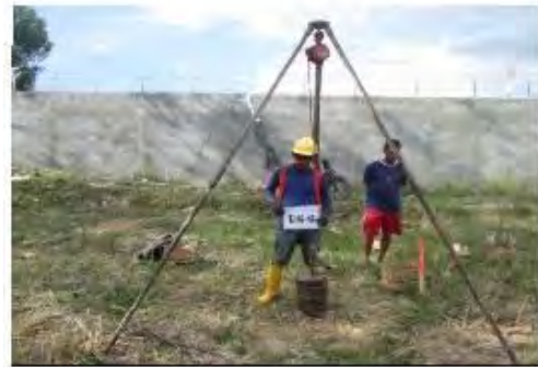
スウェーデン式サウンディング試験
