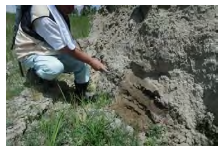
移動層の主な層相。細粒分質 の細砂を主体に構成される。
