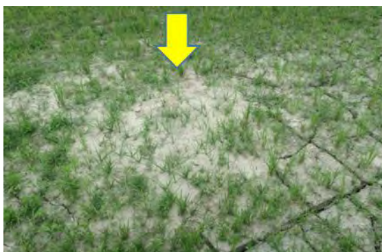
Jono Oge の南側に広がる水田の中に見られる多数の噴砂跡、噴砂の近傍の水田に新しい湧水池が出現している。
