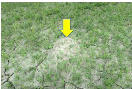
Nalodo 内部で確認された噴砂跡、展張性亀裂の隙間から噴砂が発生している。 地盤流動の完了後の最終段階に発生している。左；Petobo 頭部）
