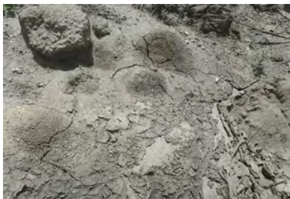
Nalodo 内部で確認された噴砂跡、展張性亀裂の隙間から噴砂が発生している。 地盤流動の完了後の最終段階に発生している。左；Petobo 頭部）
