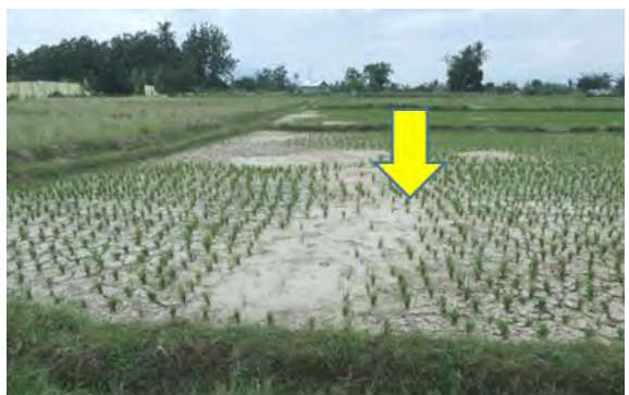
Jono Oge の南側に広がる水田の中に見られる多数の噴砂跡、噴砂の近傍の水田に新しい湧水池が出現している。
