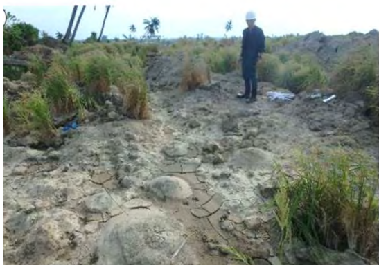
Nalodo 内部で確認された噴砂跡、展張性亀裂の隙間から噴砂が発生している。 地盤流動の完了後の最終段階に発生している。左；Petobo 頭部）
