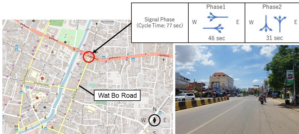
図 2.46：不適切な信号現示の例
