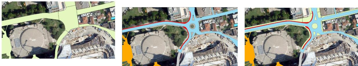
図 3-7 図化作業結果の例（左）Roadarea、（中）VehicleTrafficArea、（右）Roadarea と VehicleTrafficArea の重ね合わせ）
