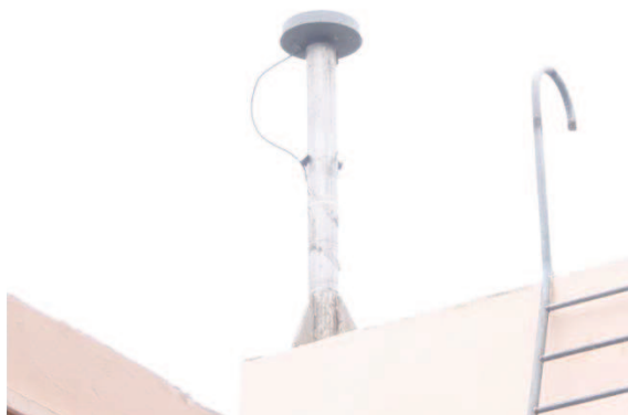
ANAT の屋根に設置されている電子基準点
