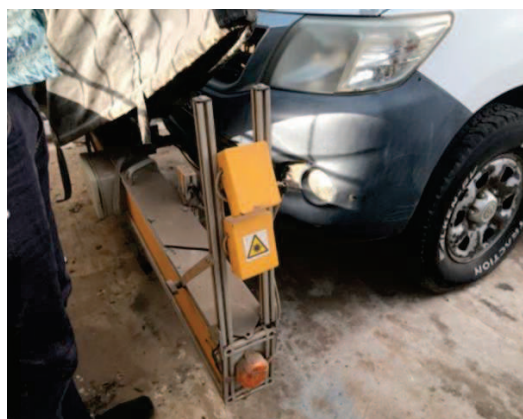
故障した路面性状調査機材
