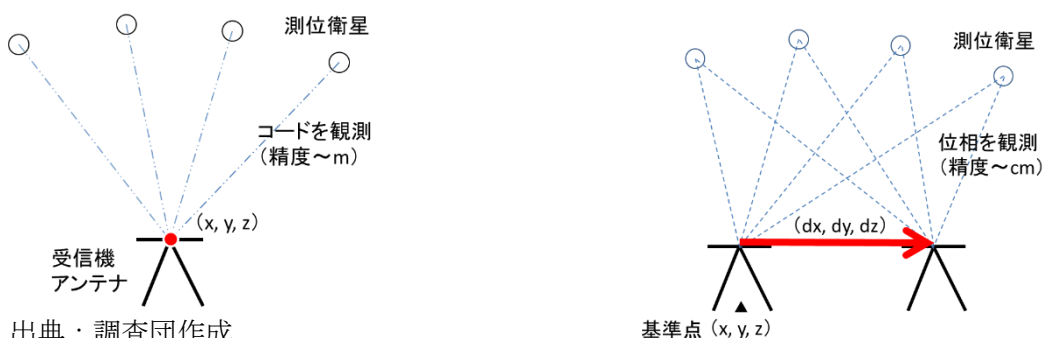
図3-3-1 衛星測位によるナビゲーション（単独測位、左）と測量（相対測位、右）
