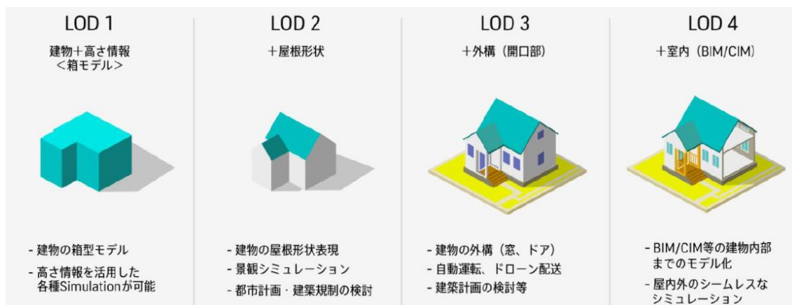
図 3-1-21 CityGML の LOD 出典：3D 都市モデルの導入ガイダンス
