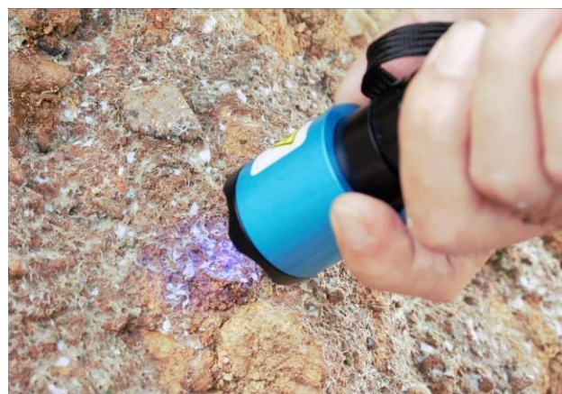
Confirmación mediante luz negra del establecimiento de alguicidas en el suelo (octubre de 2021)
