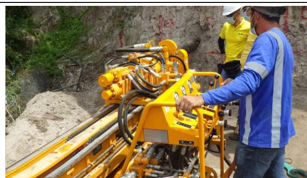
El equipo de perforación de extracción de agua subterránea de emergencia es un taladro de percusión giratorio proporcionado de forma gratuita para el desarrollo económico y social en Japón (14 de octubre de 2021)
