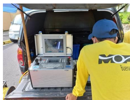
Inspección de tuberías enterradas con cámara CCTV robotizada (mayo 2021)
