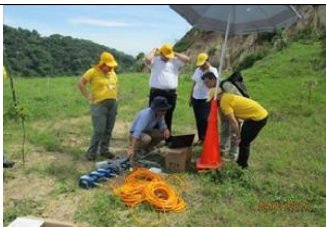
Estudio de microtemores DACGER y determinación de la velocidad media de las ondas S por debajo de los 30 m de profundidad (julio de 2017)
