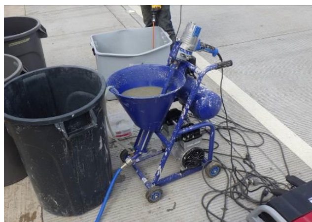
Pequeño agitador y pulverizador para la aplicación de alguicidas en el suelo para el control de la erosión (octubre de 2021)
