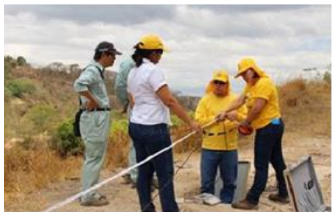
DACGER による地下水位観測井への自記水位計設置 (2017 年 7 月)
