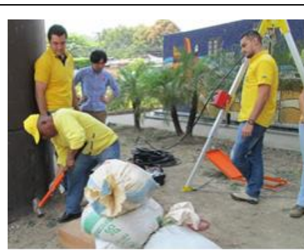
DACGERによるボーリング孔内の地震波伝搬速度検層、30m 深度以浅平均 S 波速度把握(2017 年 7 月)
