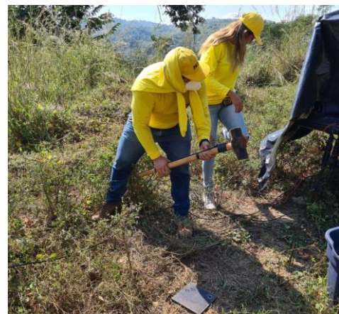
DACGER による弾性波探査(2021年 11 月)
