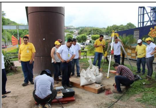
DACGERによるボーリング孔内の地震波伝搬速度検層、30m 深度以浅平均 S 波速度把握(2017 年 7 月)
