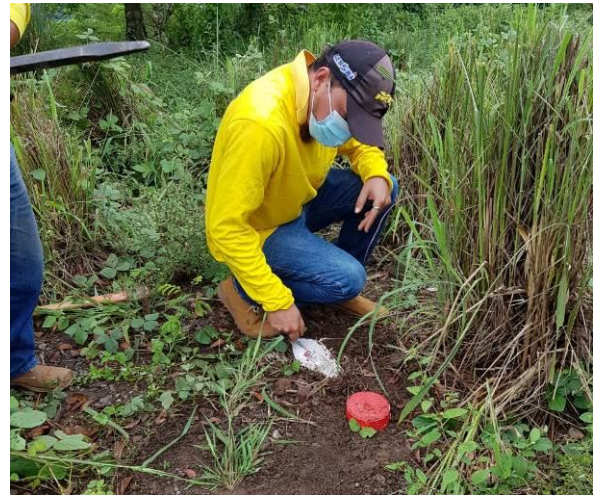
DACGER による地すべり移動杭・コントロールポイント設置 (2019年 3 月)
