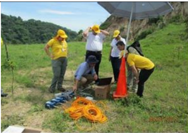
DACGER による微動探査、30m 深度以浅平均 S 波速度の把握 (2017 年 7 月)
