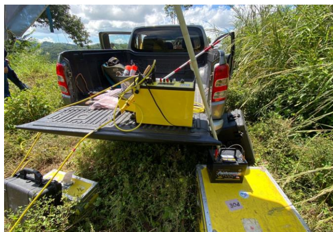
雨季の地下水位分布把握のための電気比抵抗探査 (2021年 10 月)
