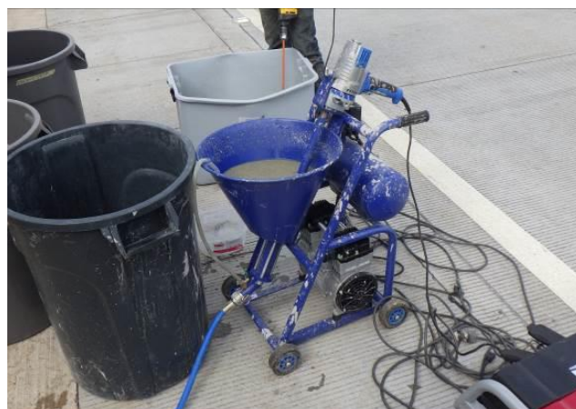
侵食抑制のための土壌藻類剤の散布用の小型攪拌・吹付機 (2021年10月)
