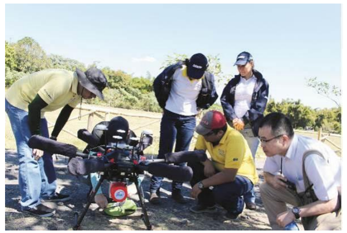
3次元レーザーキャナー (LiDAR) 搭載ドローンでのデジタル地形データ取得 (2017年1月)
