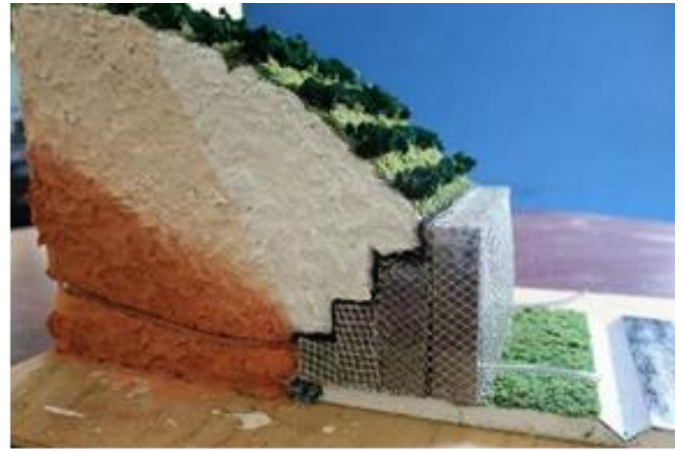
当該地点の地すべり対策工のスケールモデル、DACGER の指導により、インターンシップの高校生が作成 (2017 年 9 月)、コスタリカ国の山岳道路フォーラム等で展示
