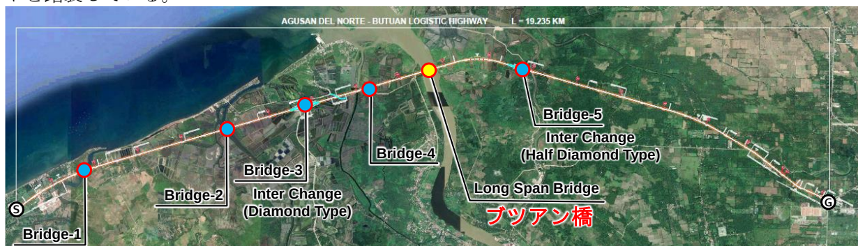
図 18-3 線形計画及び主要構造物箇所
