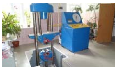
Испытание на сжатие и испытания на изгиб. Оборудование для испытания арматуры на растяжение
