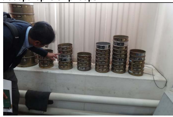
Фото 4: Сита для определения размеров щебня и песка
