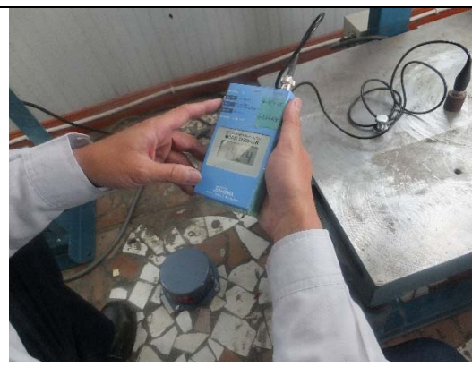
Фото 4: Проверка вибрационной плиты ВС прибора
