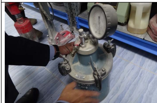
Фото 3: Прибор для замера воздуха в составе бетонного раствора
