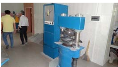
Испытание на сжатие и испытания на изгиб. Оборудование для испытания арматуры на растяжение
