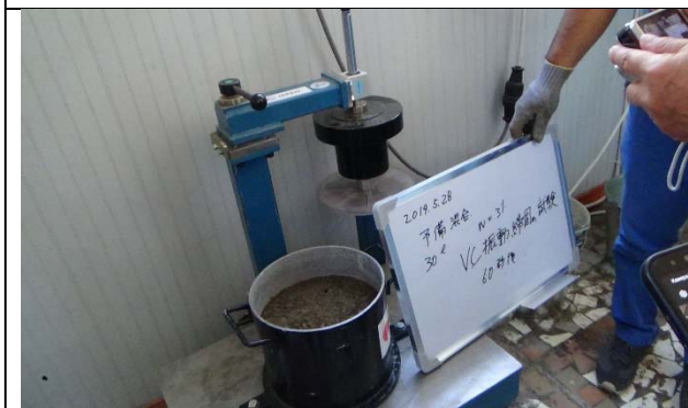
Фото 3: Испытание на VC приборе.
