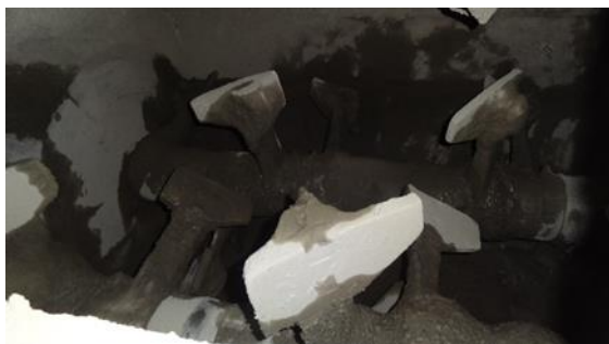
Внутри смесителя: 2-х осевая мопс, очищенная
