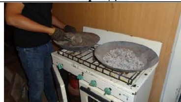
Фото 4: Измерение влагосодержания материала газовой плитой
