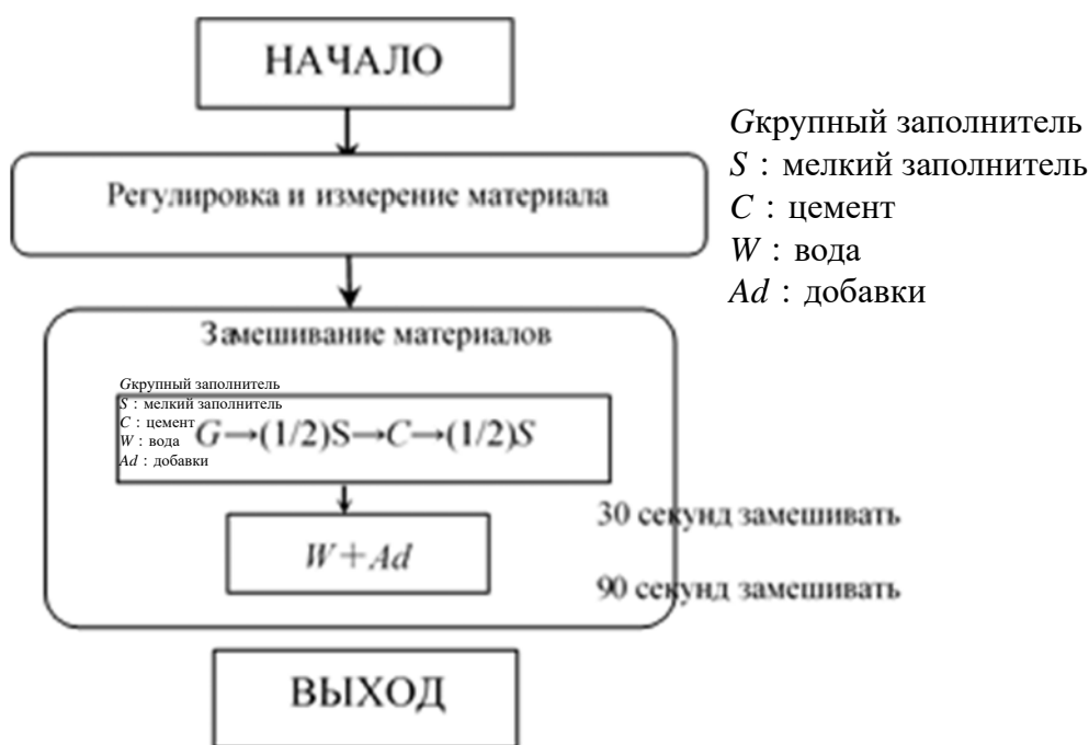
Рисунок 2-2 Способ замешивания в помещении
