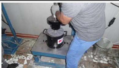
Фото 3: Испытание на виброуплотнителе VC. Оценка выделения раствора из УУБ и уровня уплотняемости.
