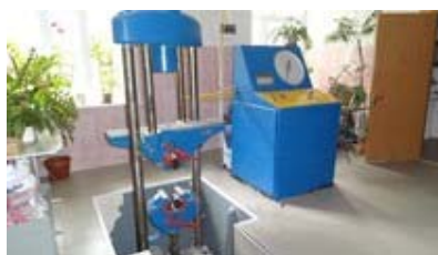
鉄筋引張試験装置
