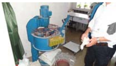
室内生コンミキサー
