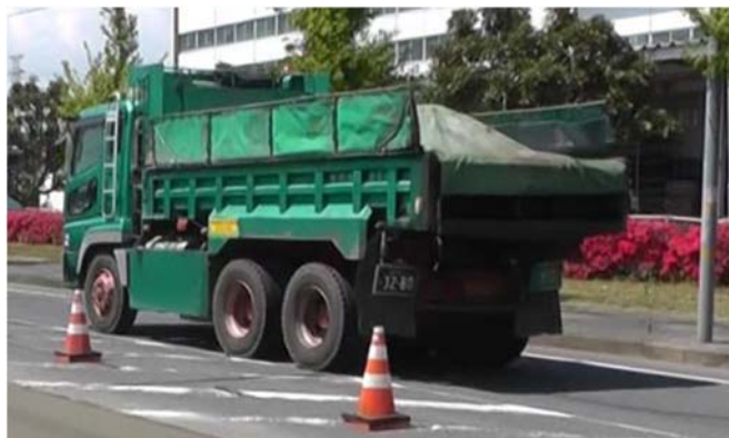
シート掛け状況写真
