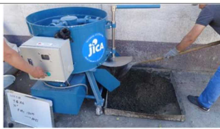
写真2: 室内ミキサによるコンクリート製造
