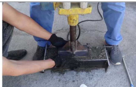
写真4: ボッシュタンパを使用した曲げ強度試験 用供試体作成状況
