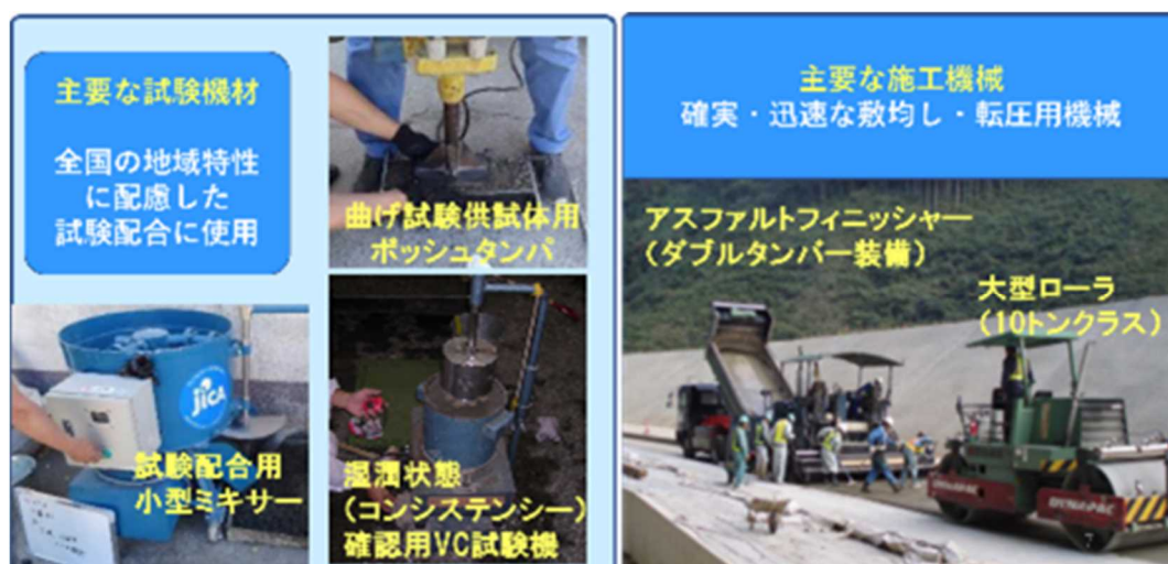
図 3-5 RCCP の主要な試験・施工機材
