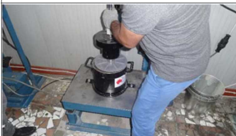
写真2: VC 振動締め試験 RCC 中のモルタルの浮き上がり状況や 縮まり具合を評価
