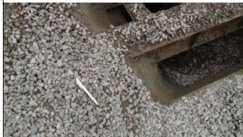
写真3：粗骨材（砕石 10mm）川砕：色々な岩質混在
