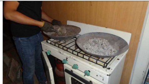
写真 4 : ガス直火法による骨材含水比測定
