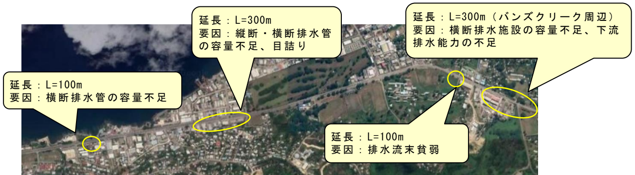
図 3-14 4車線区間の冠水箇所
