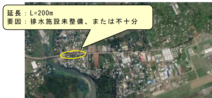
図 3-15 2車線区間の冠水箇所
