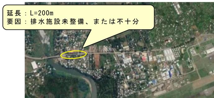
図 3-15 2車線区間の冠水箇所
