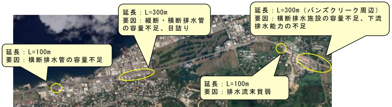
図 3-14 4車線区間の冠水箇所
