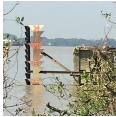
モンキーポイント既存潮位観測標 (2017年12月の船舶衝突による崩壊後、2019年初 頭に設置) (新規気象海象観測所設置予定地付近)
