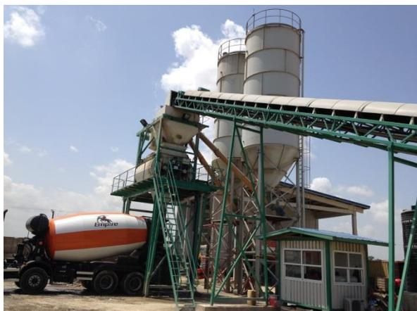
写真 3.2-1 稼働中の生コン工場
