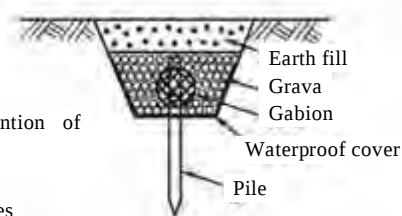
Fig. 4.6 Gabion drainage conduit
