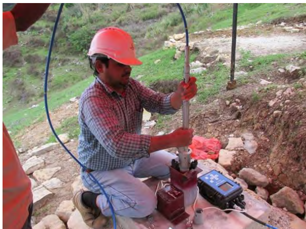
Figura 21 — Inserção da sonda do inclinômetro nas carcaças
