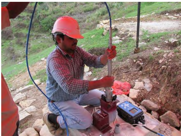
Figura 21 — Inserção da sonda do inclinômetro nas carcaças
