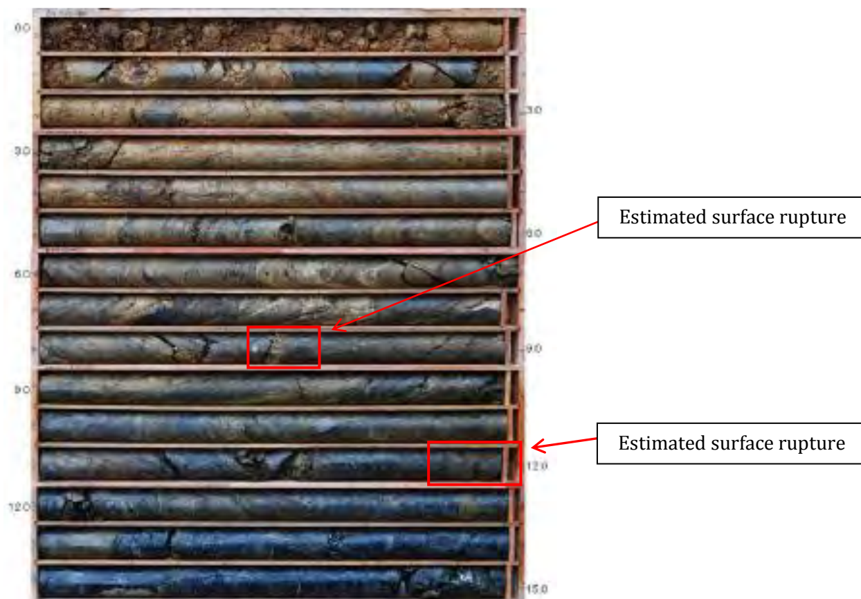
Figura 19 — Amostragem prinsipal la perturbada simples iha movimentasaun massa
