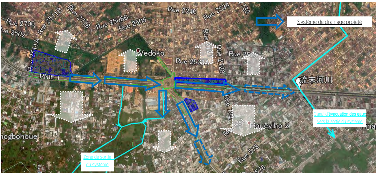
Figure 2.28 : Schéma du système de drainage projeté
