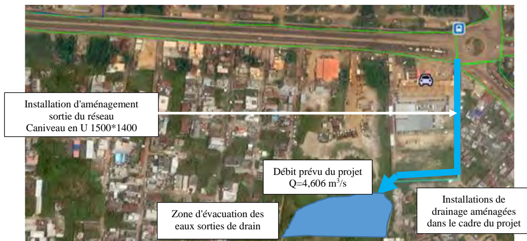
Figure 2.32 : Plan de raccordement de la sortie du système de drainage
