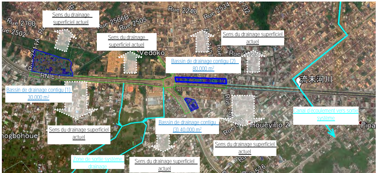
Figure 2.27 : Schéma du réseau de drainage actuel
