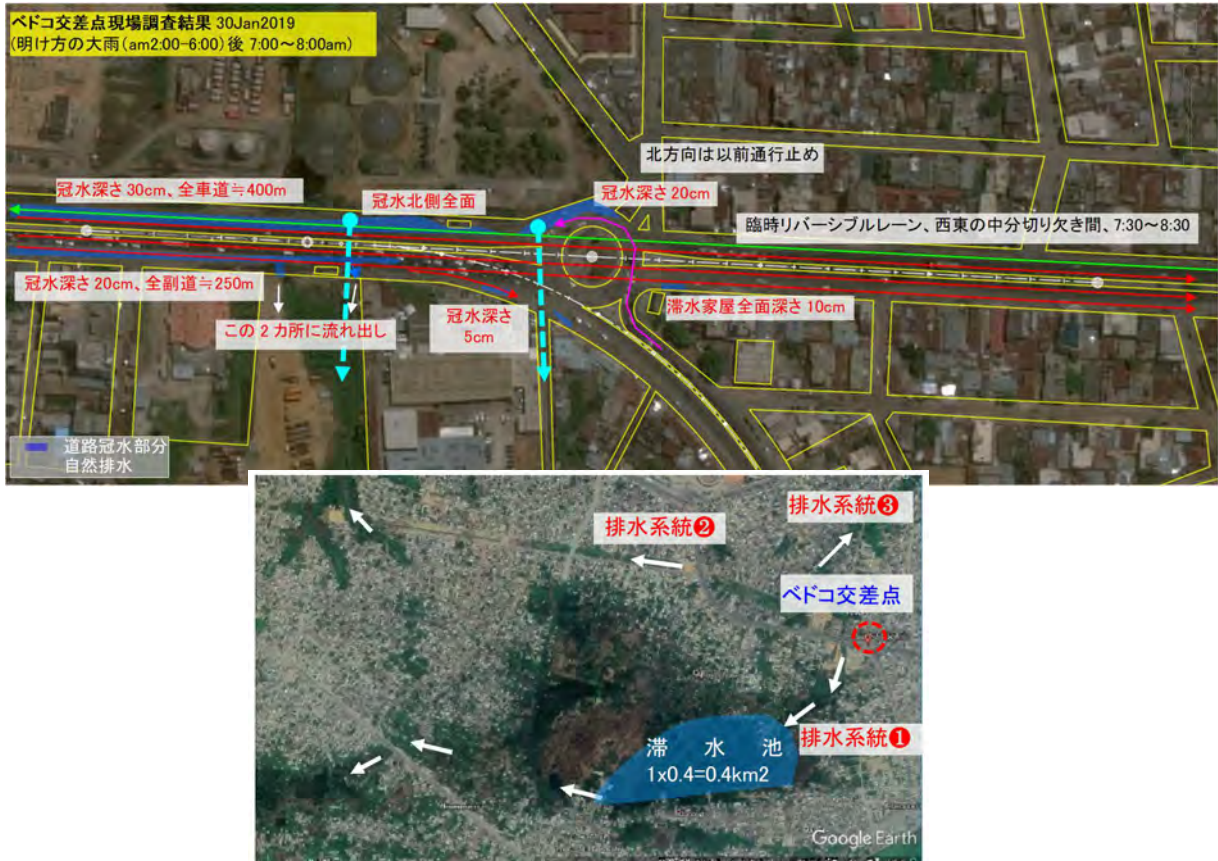
大雨(am2:00-6:00)後の朝のトヨタ前交差点現場調査結果(30Jan2019, 7:00-8:00am)
