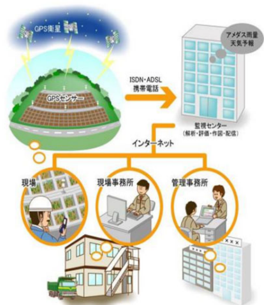
図 311 shamen-net サービスのシステム構成
