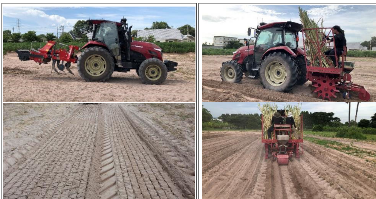
図 57 左上：ミニコンバイン、左下：作業後の様子、右上：シュガーケーンプランター、右下：作業後の様子
