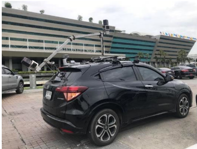
図 13 Iwane Mobile Mapping System 概観 (IMS3)
