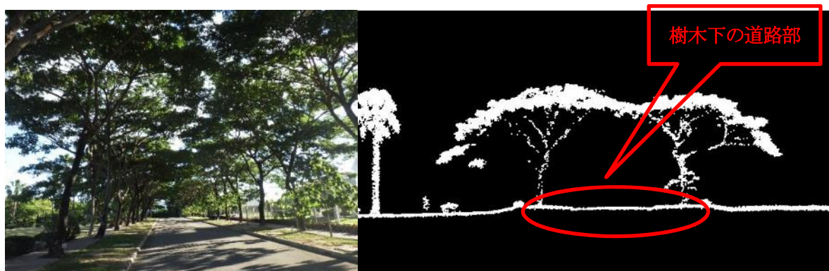
図 25 樹木下のデータの取得状況（左側：現地写真 右側：データの取得状況）
