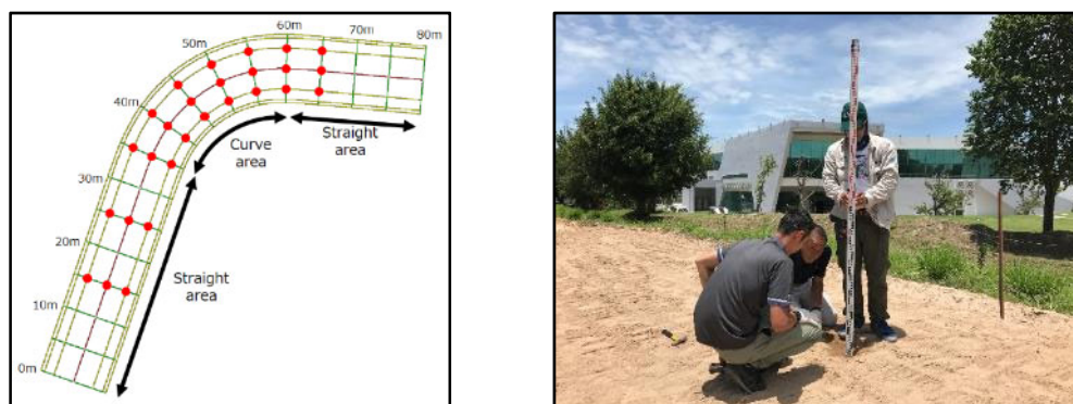
図 49 左：高さ杭の位置、右：高さ調整作業
