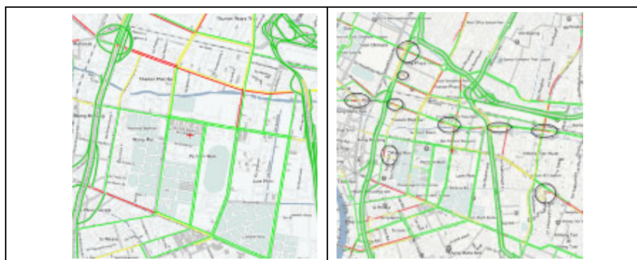
図 3-16 設置型のセンサー（左）とプローブデータの比較（右）
