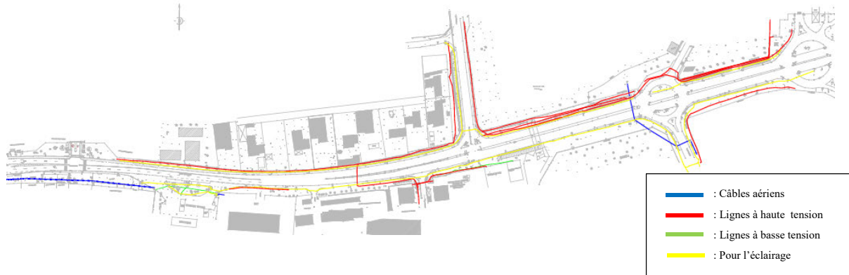
Figure 3.2.1 Carrefour de l'École de police / plan d'ouvrage fini (électricité)
