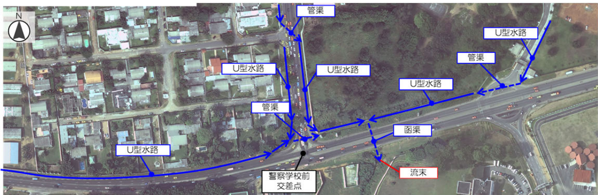
図 7.1.1 警察学校前交差点 現況排水系統
