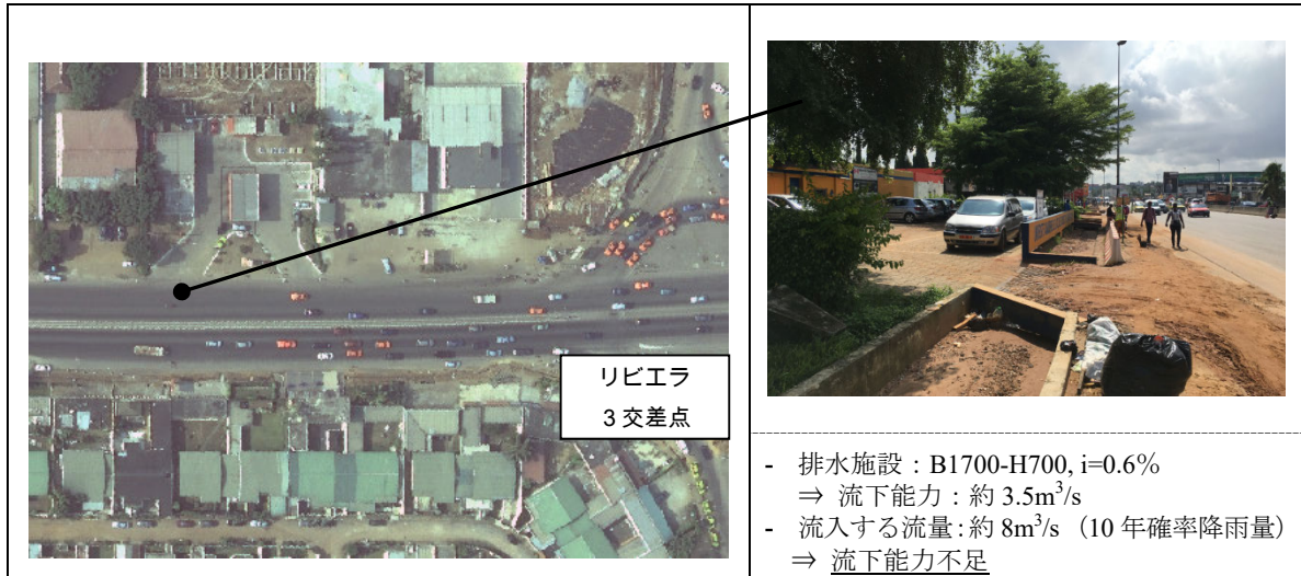
図 3.1.11 リビエラ 3 交差点北側水路の流下能力
