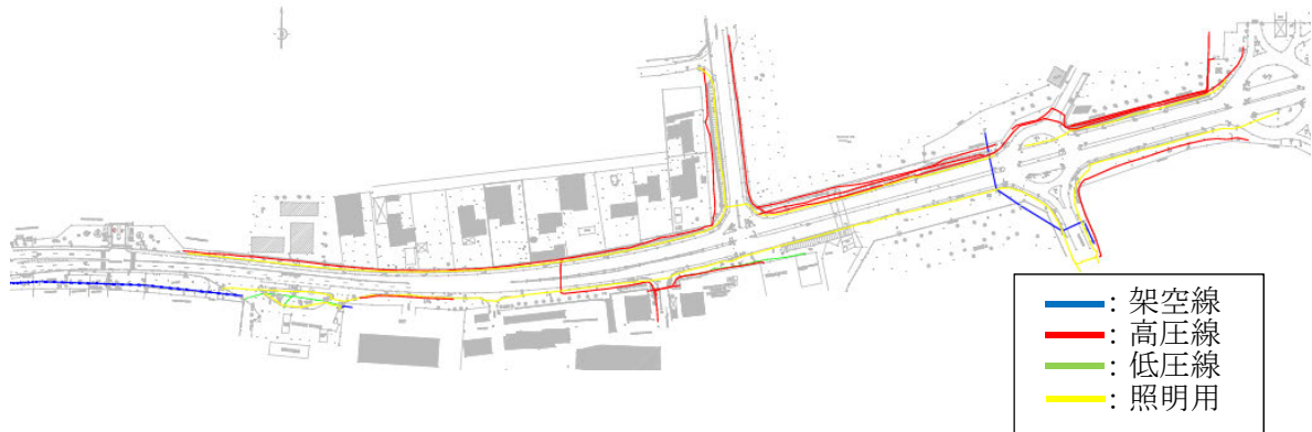
図 3.2.1 警察前学校交差点 / 現況図（電力）
