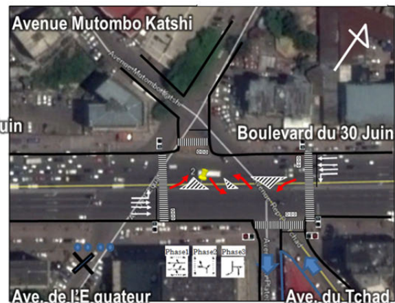
Figure 8.3.10 Idée conceptuelle de l'amélioration des intersections (Grande intersection)
