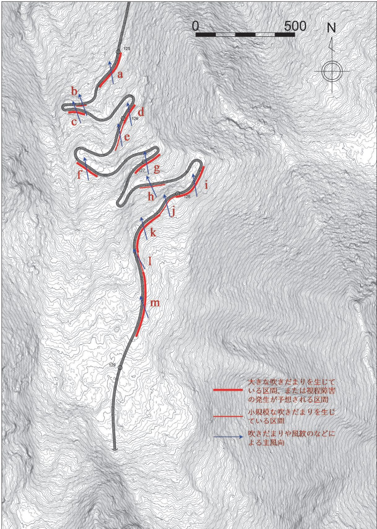
図 2-2-4.3 Too-Ashuu 島の吹きだまり発生状況
