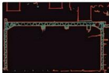
[3次元点群データ輪郭線自動抽出の状況]
