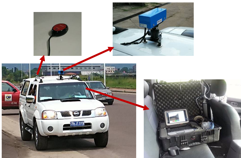
Fig 5. Vue des équipements pour l'inspection routière
