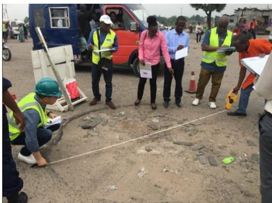
Formation sur l'inspection de routes, mesure de nids de poule, enregistrement de l'état de dégradation (12/06/2018)
