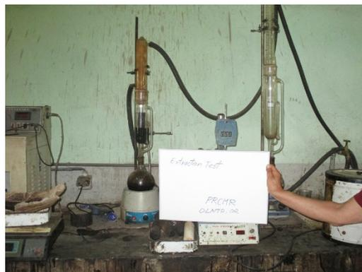
Laboratoire (Essai de la quantité d'extraction d'asphalte)
