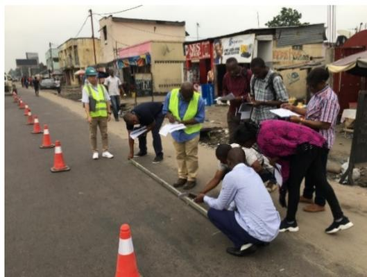
Formation sur l'inspection de routes, mesure de la planéité de la chaussée (14/06/2018)
