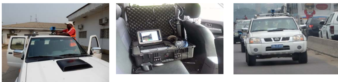
図 2.8 車載型道路点検機材
