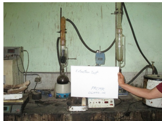
試験室(アスファルト抽出量試験)
