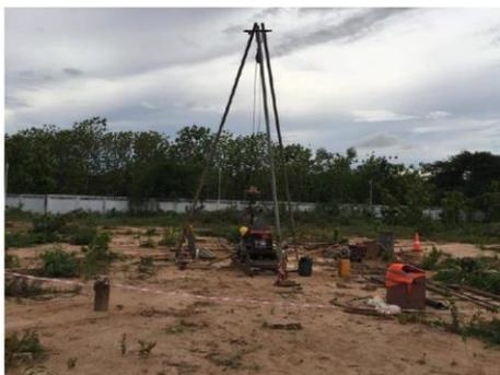
写真 2-7 標準貫入試験準備工
