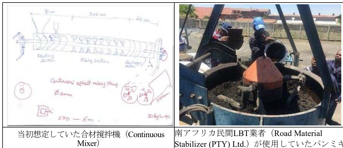
図 3-1 当初想定していた合材攪拌機と Pan Mixer の比較
