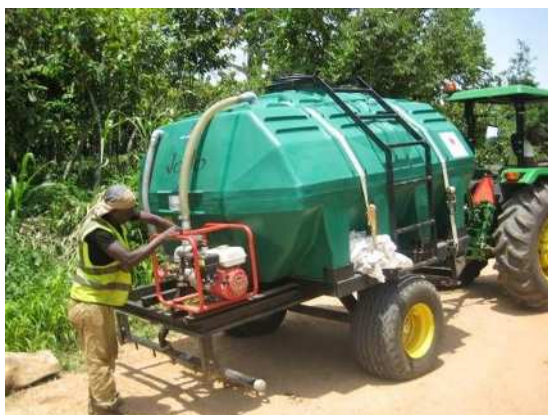
写真-40 水タンク車/ エンジンポンプ
