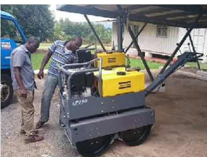
写真 28 ペDESTリアン ローラーの納入。 エンジンを かけ、作動する ことを確認した。 。
