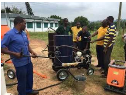
写真 24 機械式アスファ ルト噴霧器の納 品。水で実際に 機能しているこ とを確認する
