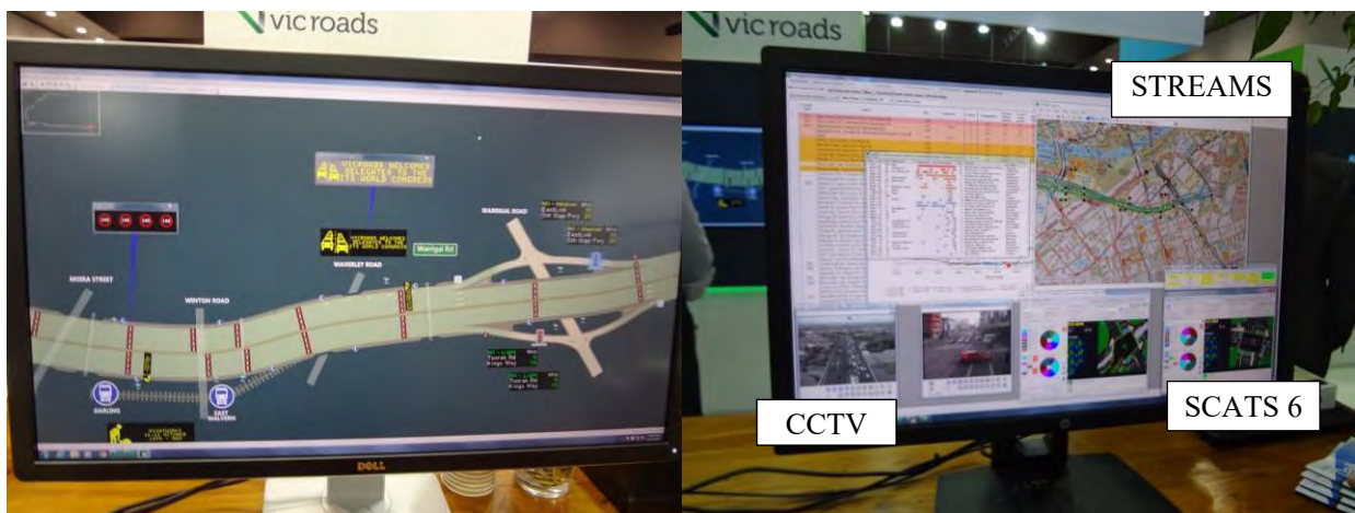
図 4-1 VicRoads の交通管制モニタリング、コントロール画面
