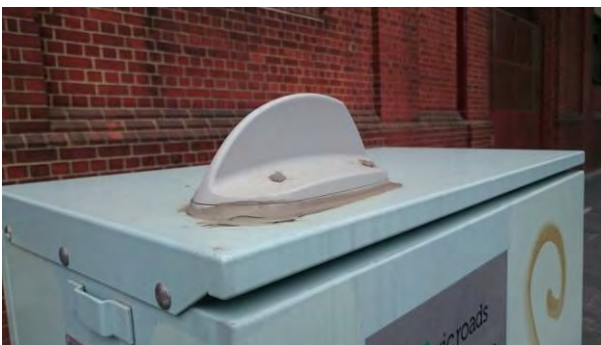
図 4-3 市内に設置している Bluetooth ビーコン (左) Bluetooth の解析画面 (右)
