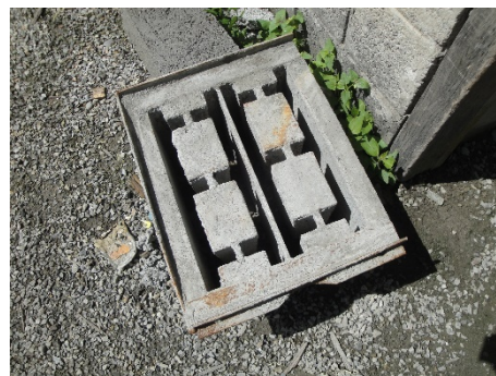
図 2.4.2 改良したコンクリートブロック型
