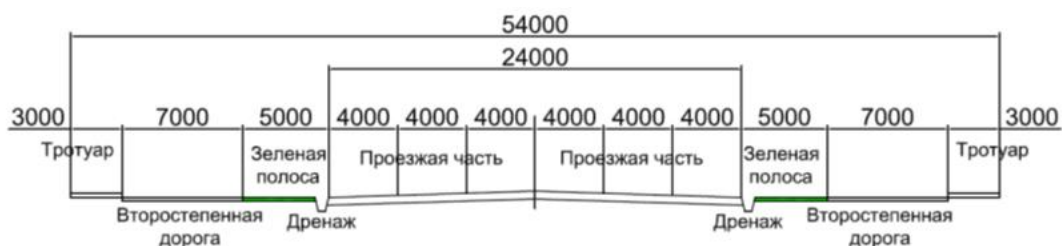
Рисунок 2.2-3 Поперечный профиль дороги, предусмотренный в Генплане развития г. Бохтар
