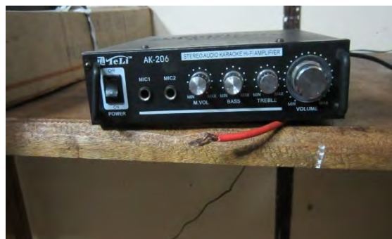
写真-16：インカムの代わりに使用されているカラオケアンプ。本来スピーカーを接続する所にヘッドホンを接続しており、大音量となる可能性があり危険。
