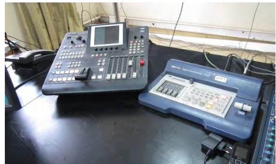
写真-8 : 2台のカメラ映像をそれぞれのスイッチャーに入力して使用しているとの事。
