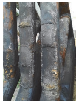
図 2-7 HOB 施設と交換された水管の修理跡 (JICA 調査団撮影)
