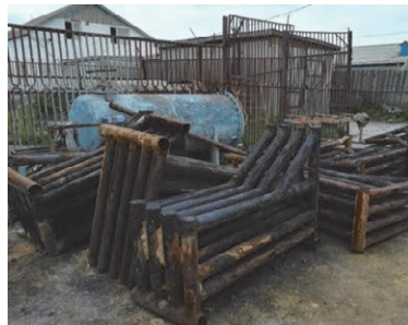
図 2-7 HOB 施設と交換された水管の修理跡 (JICA 調査団撮影)
