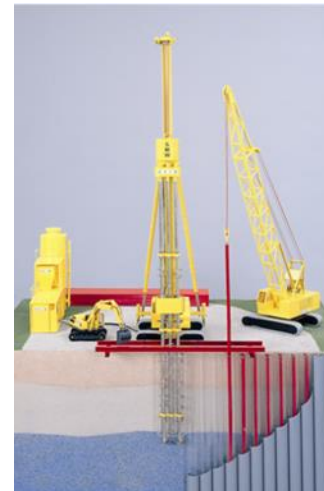
Hình 8.8-2 Phương pháp thi công tường xi măng trộn đất (Hình vẽ tham khảo)
