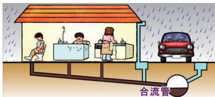
図 7.1-2 合流式下水道のイメージ図
