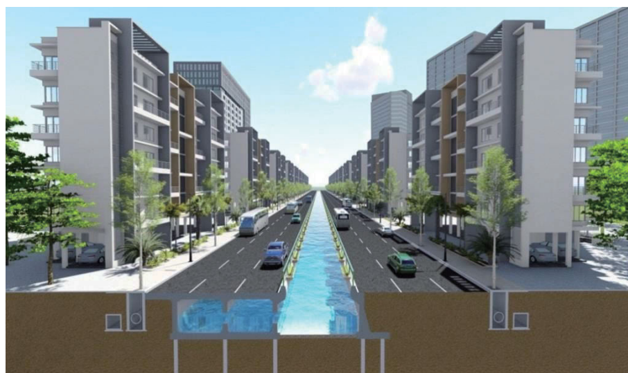
図 2.1-1 ボックスカルバートと開渠による整備イメージ図
