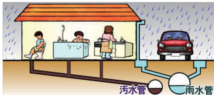
図 7.1-1 分流式下水道のイメージ図
