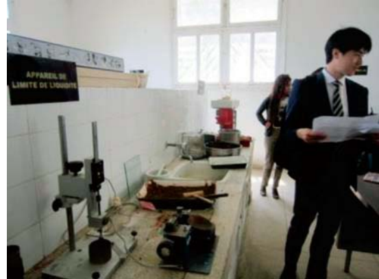
土質試験機器（液性限界の測定機器） ほかにアスファルトの材料試験機器（マーシャ ル試験器や物性試験の機材）もある。
