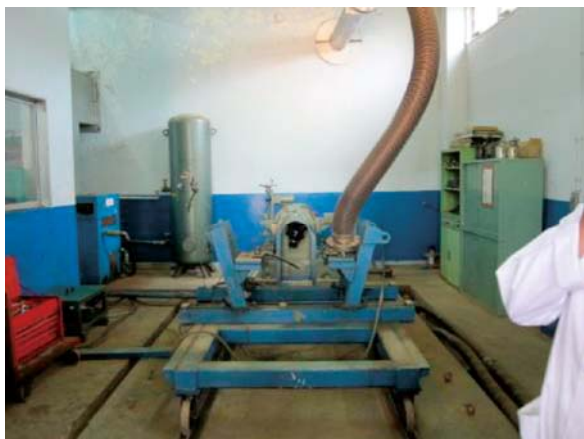
排気ガス、駆動力その他の計測によりエンジンの状態を測定するエンジンテスター
