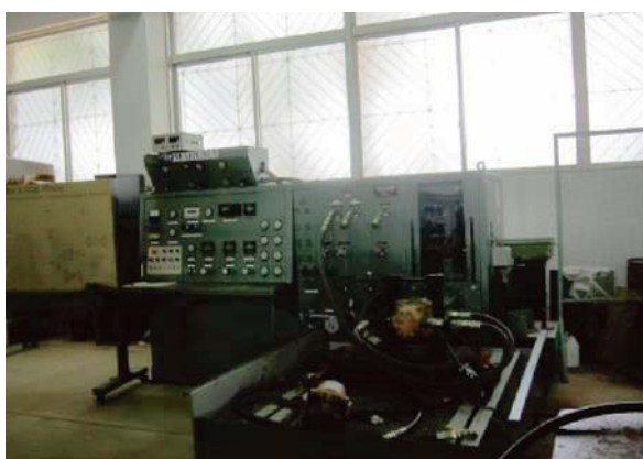
油圧系の診断を行う油圧テスター。無償資金協力供与機材（マルマ製）
