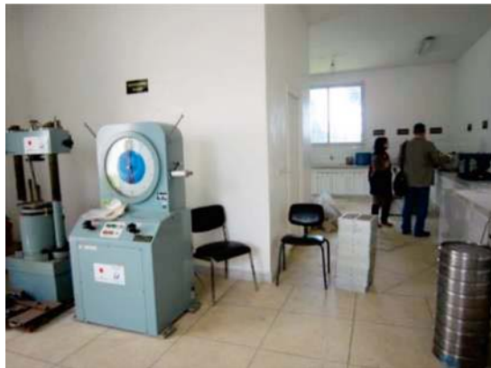
セメントコンクリーの試験器 手前は強度測定用の圧縮試験器、奥にはスラン プ試験器等もあった。
