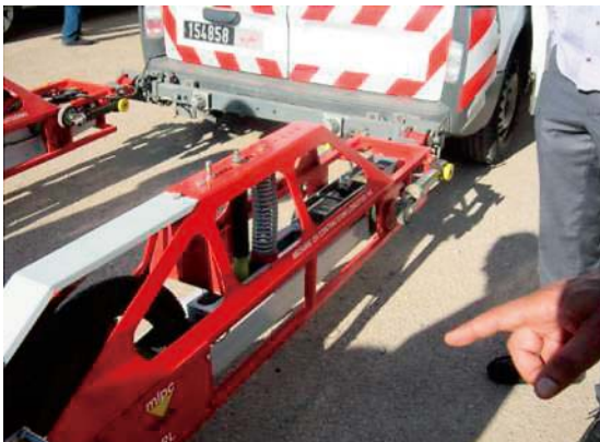
CNERの保有機材 路面平坦性を測定するプロファイラーとそれをけん引する車両
