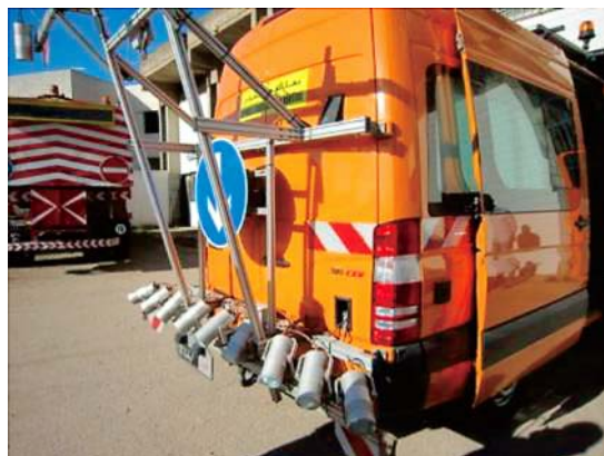
フランス製の路面のクラック計測車両
