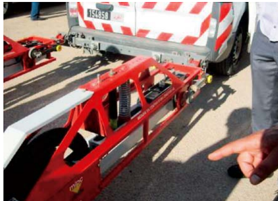
路面の凹凸度を測定するプロファイラーとそれをけん引する車両
