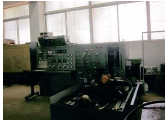
油圧系の診断を行う油圧テスター 無償資金協力供与機材（マルマ製）
