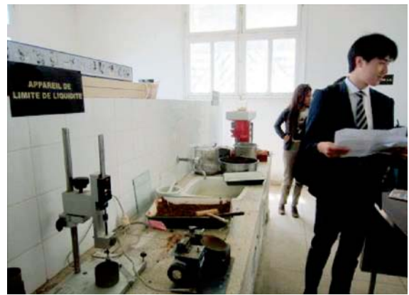
土質試験機器（液性限界の測定機器）。他にアスファルトの材料試験機器（マーシャル試験器や物性試験の機材）もある。
