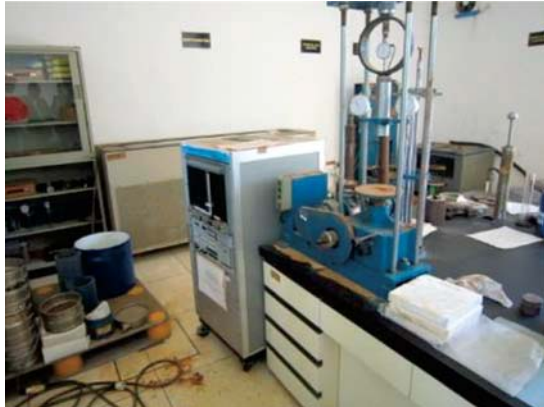
材料試験棟の土質試験関係機器 （左は粒度分布計測用のふるい、真ん中は一軸 圧縮試験機）
