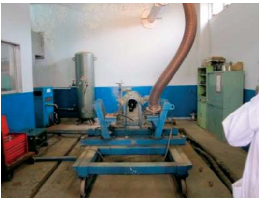
排気ガス、駆動力その他の計測によりエンジンの状態を測定するエンジンテスター
