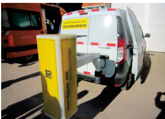
舗装厚を測定する米国製の地中レーダー
