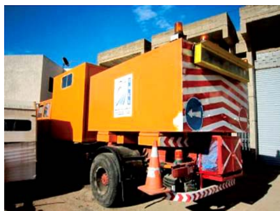
レーザープロファイラーを積載した路面平坦性の計測用車両（ドイツ製）解析室もセットされているが、日本の路面性状調査車両のように凹凸、ひび割れ率、その他の計測を1台でできる機材の供与を希望している。この車両は計測時には時速6kmで走行（日本では時速60kmで計測可能）
