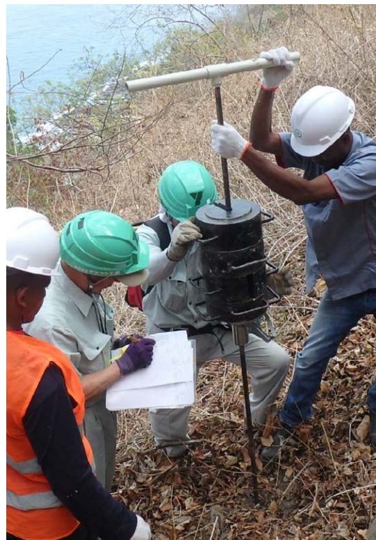
国道3号線：KP66+775~999での簡易貫入試験
