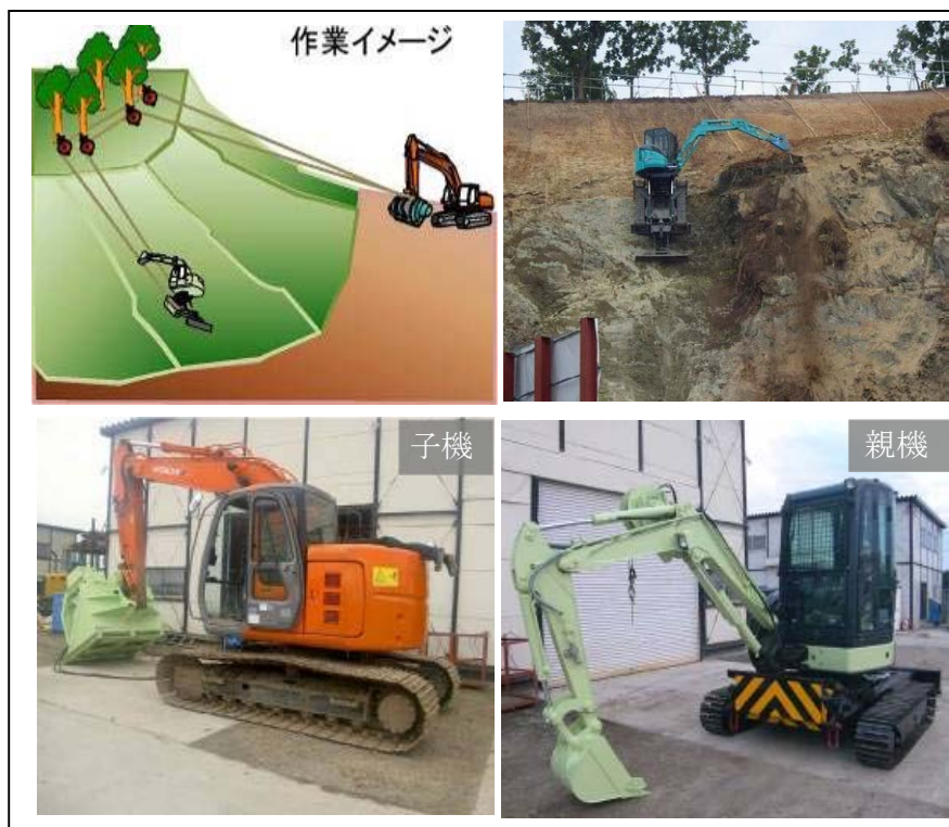
図 2-1:SSMC 掘削工法 (A 機種による)
