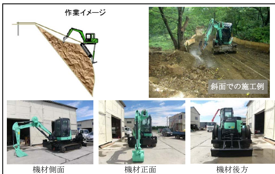
図 2-2:SSMC B 機種(C 機種も同様)
