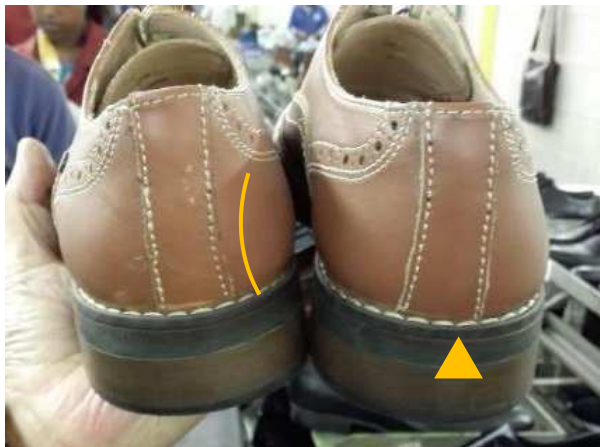
写真10：ライン検品でのソール不良。左：曲がり右：センターのずれ
