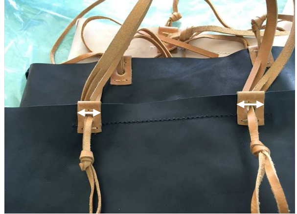
写真8：サンプル発送前の検品。ハンドル付け根、革の左右のサイズ違い。(2018.12)
