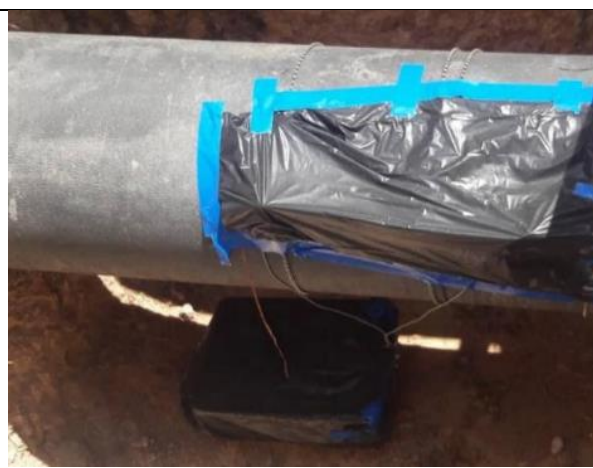
無取水ベースライン調査での超音波流量計による 流量測定
