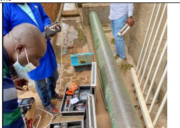
超音波流量計調査の様子
