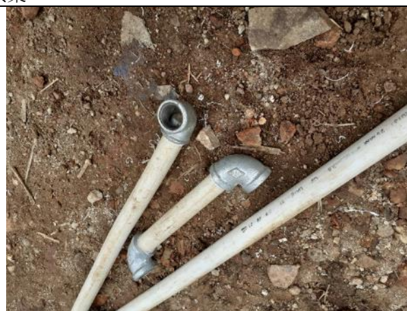
質の悪い給水機材の例 (PVC 管に铸铁异形管を ねじ込み配管)
