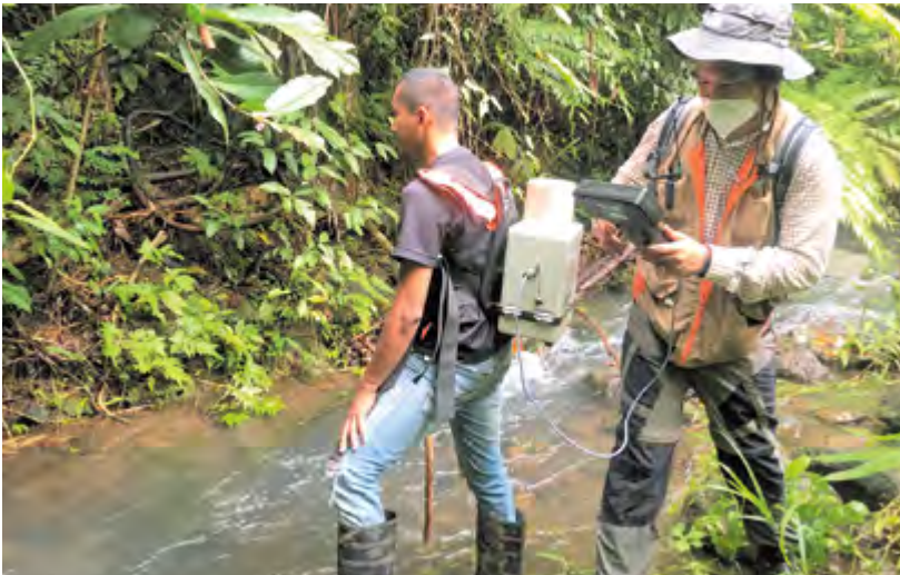
フィリピン:ルソン島カマリネス・ノルテ州のフィールドで物理探査(VLF法)を行う研修員
