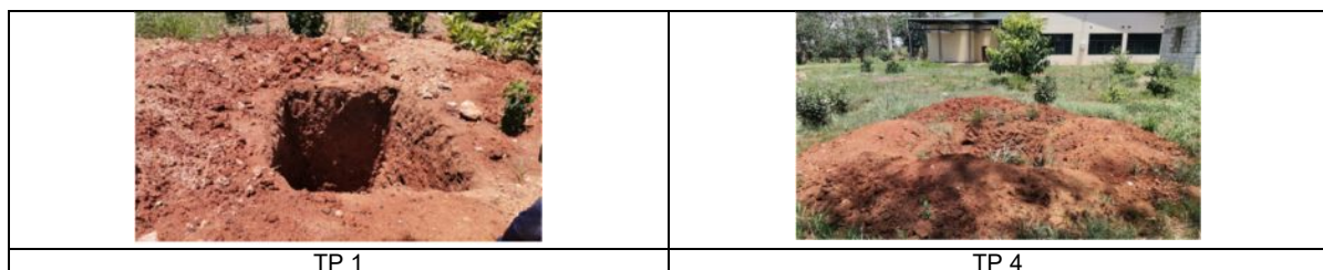
図 -1-3 マウント・マクル建築施設建設予定地のテストピット状況
