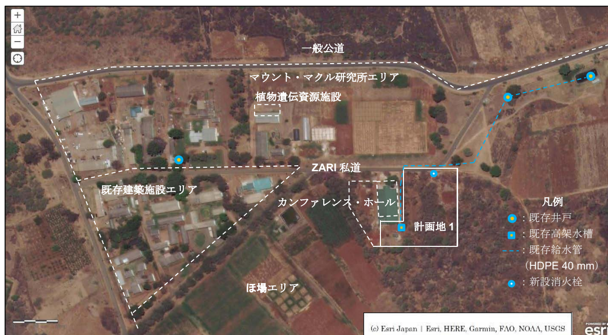
図 3-2-18 マウント・マクル研究所の給水状況と計画地 1 の位置関係
