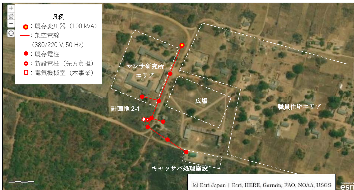
図 3-2-17 マンサ研究所の受電・配電状況と計画地 2-1 の位置関係
