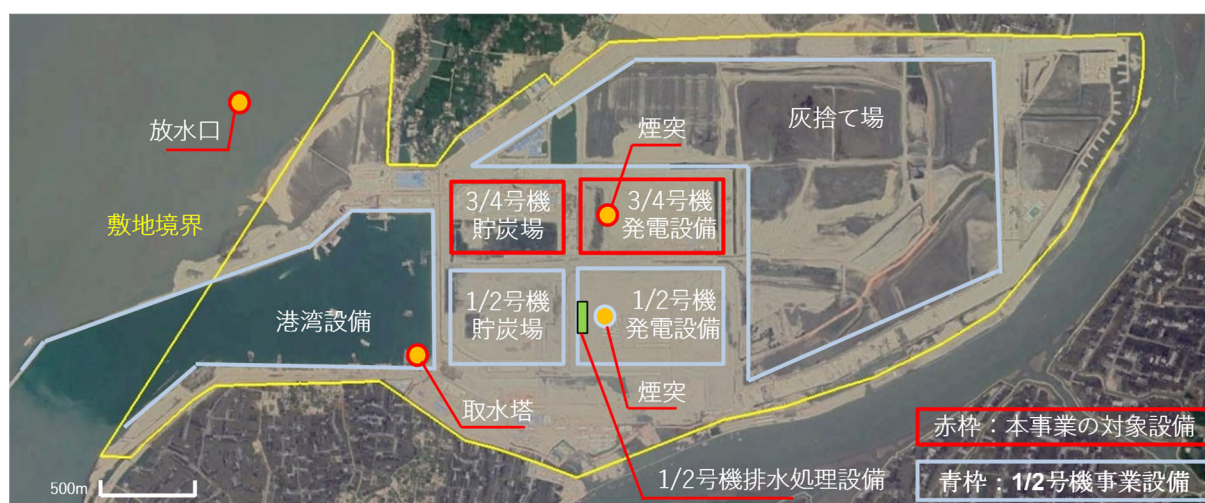
図 1.2-2 本事業の対象設備と 1/2 号機事業設備の概略配置
