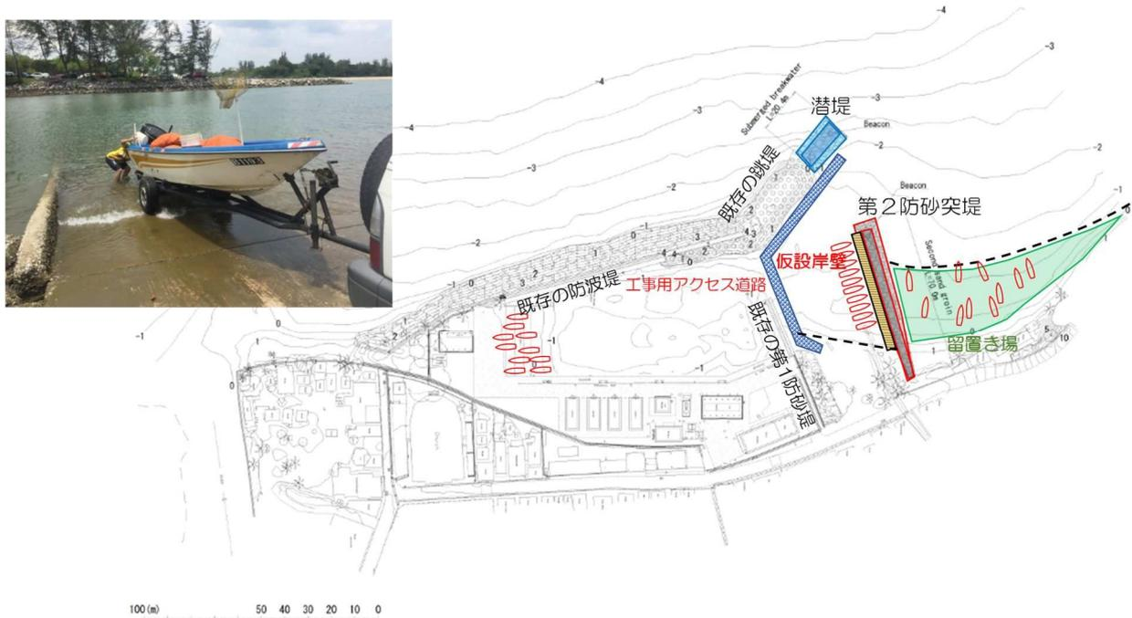
図 4-2-2-1(10) 船台(ボートトレーラー)による漁港と仮設岸壁間の漁船の移動
