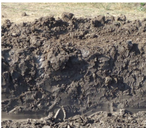
写真 4.2 湿った状態のブラックコットンソイル (粘土状)
