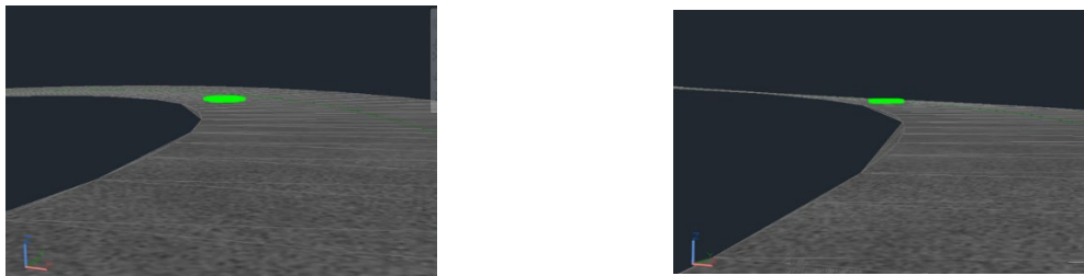
下り勾配と曲線：見通しが良く、曲線も小さく見える。
