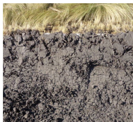
写真 4.3 乾燥状態のブラックコットンソイル (CBR調査等では高強度を示す場合がある)
