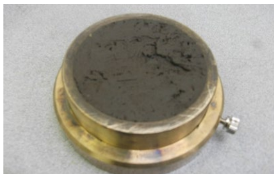
写真 4.4 不飽和状態のブラックコットンソイル 写真 4.5 飽和状態のブラックコットンソイル
